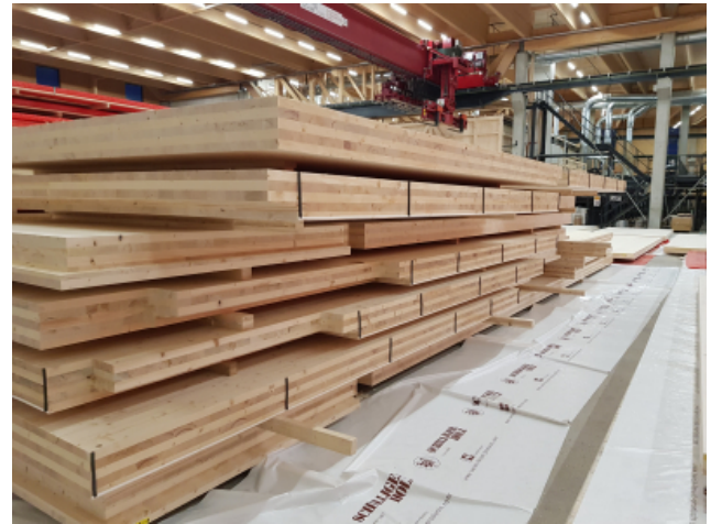
Vorbehandelte CLT-Platten im Werk
