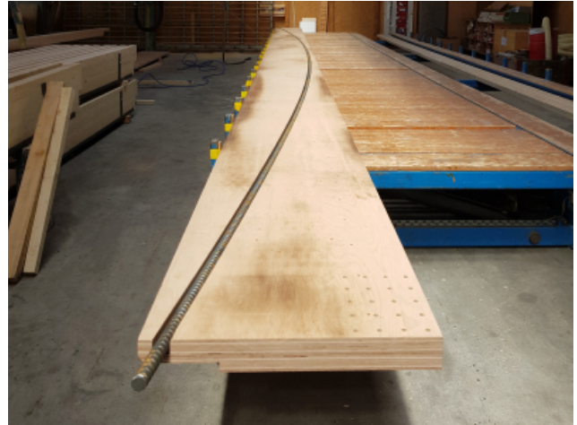
Im Detail: fischbauchförmig eingefräste Vorspannstange im Buchenträger
