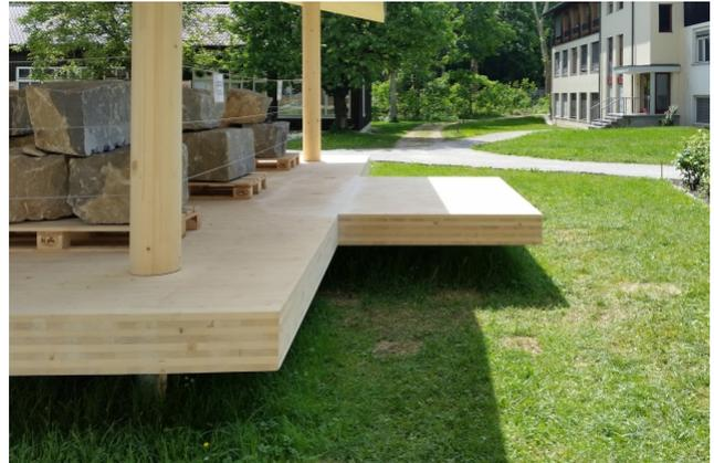
Stützen, Platten, fertig: Im Innenhof der Berner Fachhochschule in Biel steht ein Dauerprüfstand mit der neuen TS3-Technologie und dem weltweit ersten stirnseitig verklebten Balkon. Damit werden die neuen Möglichkeiten für den Holzbau deutlich aufgezeigt.
