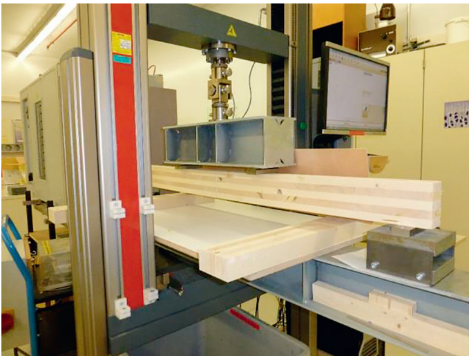
Abb. 20: Prüfanordnung für Biegeprüfungen an CLT-Trägern
