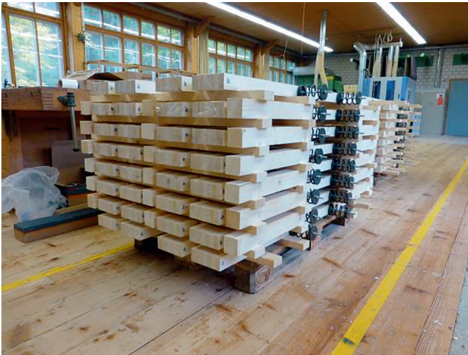
Abb. 19: Langzeit-Biegeversuche an CLT-Trägern mit verklebter Stoßfuge in der Mitte des Prüfkörpers
