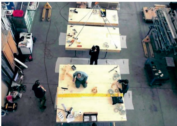
Abb. 22: Verklebung der CLT-Elemente für die Grossbrandprüfung
