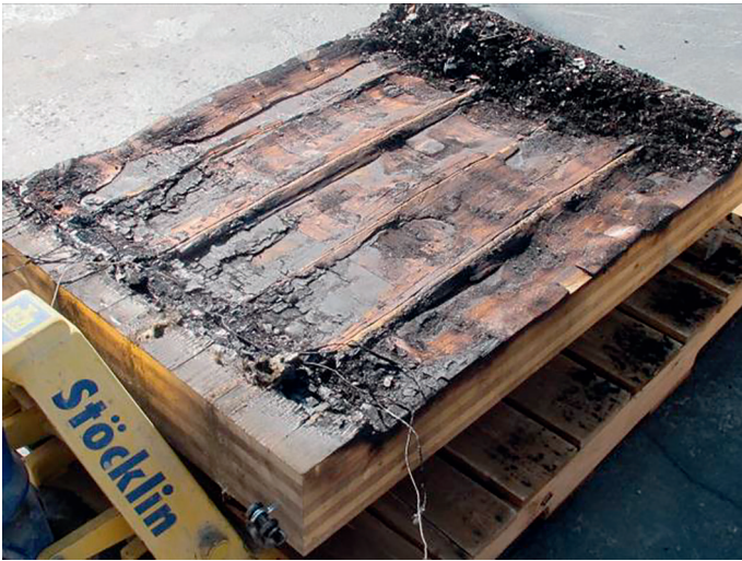
Abb. 21: Kleinbrandversuche an Prüfkörpern aus Fichte CLT und Buchensperrholz nach dem Entfernen der Kohleschicht
