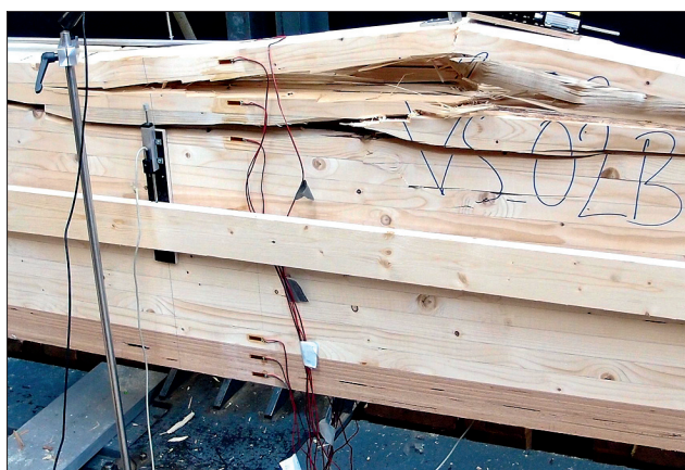
Wird Brettsperrschichtholz aus Fichte auf der Zugseite mit Furnierschichtholz aus Buche oder Birke verstärkt, so muss mit einem Versagen dieses Verbundträgers in der Druckzone (also auf der Oberseite) gerechnet werden. Foto: MPA Stuttgart
