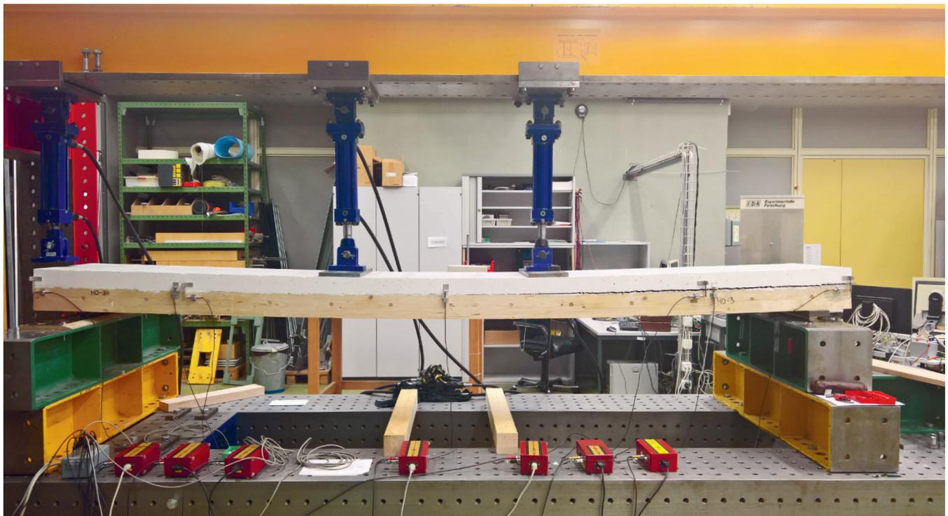
*Vier-Punkt-Biegeversuch: Prüfeinrichtung mit eingebautem, bereits getestetem Prüfkörper und bereits getesteter Messtechnik. Die rechte Seite hat versagt.*
