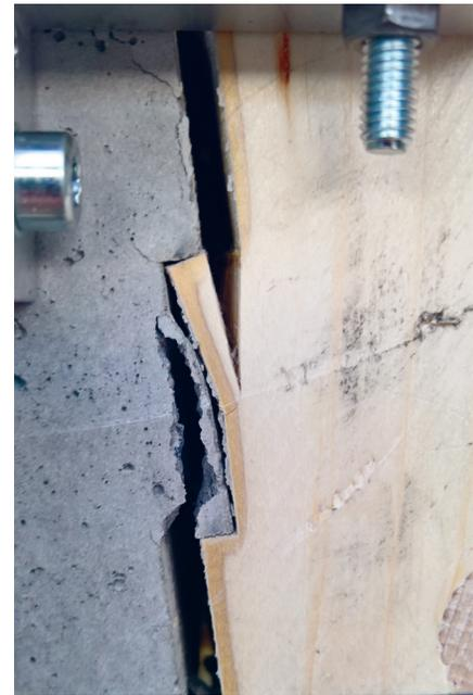
Push-out-Versuch: Scherversagen von Beton und Holz gleichzeitig.
