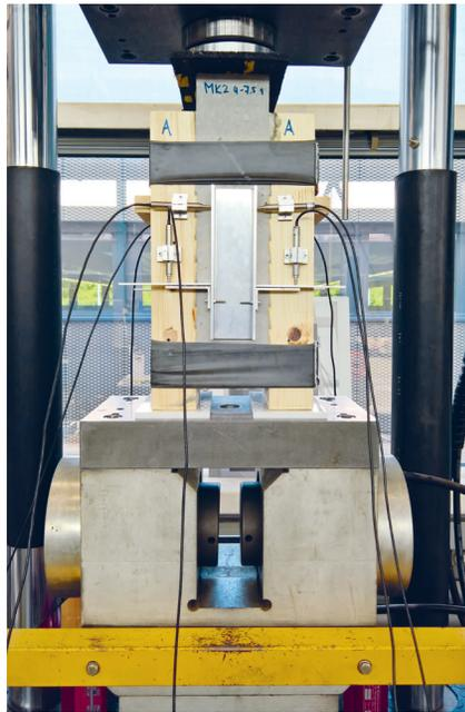
Push-out-Versuch: Prüfeinrichtung und eingebauter Prüfkörper mit Messtechnik.
