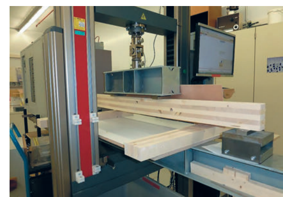
Рис. 20. Испытательная установка для испытаний CLT-балок на изгиб
