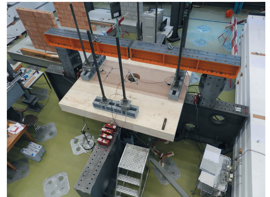
Рис. 9. Испытание элемента центральной плиты в ETH Zurich
