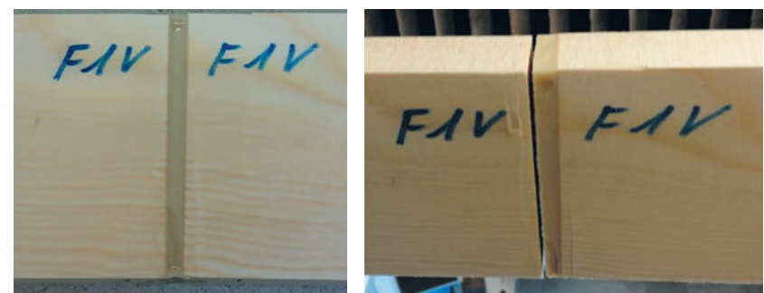
Рис. 13. Стыковое клеевое соединение ламелей [6]
