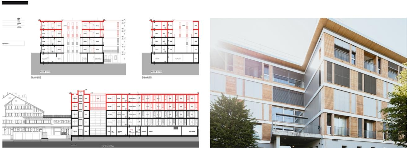
Le centre de soins et de retraite d'Esslingen avait besoin d'espace supplémentaire. Grâce à la technologie innovante TS3, la structure porteuse existante a pu être reprise et le bâtiment agrandi de deux étages. Le temps de construction réduit, l'utilisation de bois régional et la flexibilité de l'aménagement de l'espace grâce à la technologie TS3 font de ce bâtiment un projet exemplaire en matière de construction durable.
