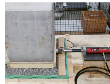
Versuche im Labor zur Bestimmung von Reibbeiwerten zum Nachweis der Stand- sicherheit
