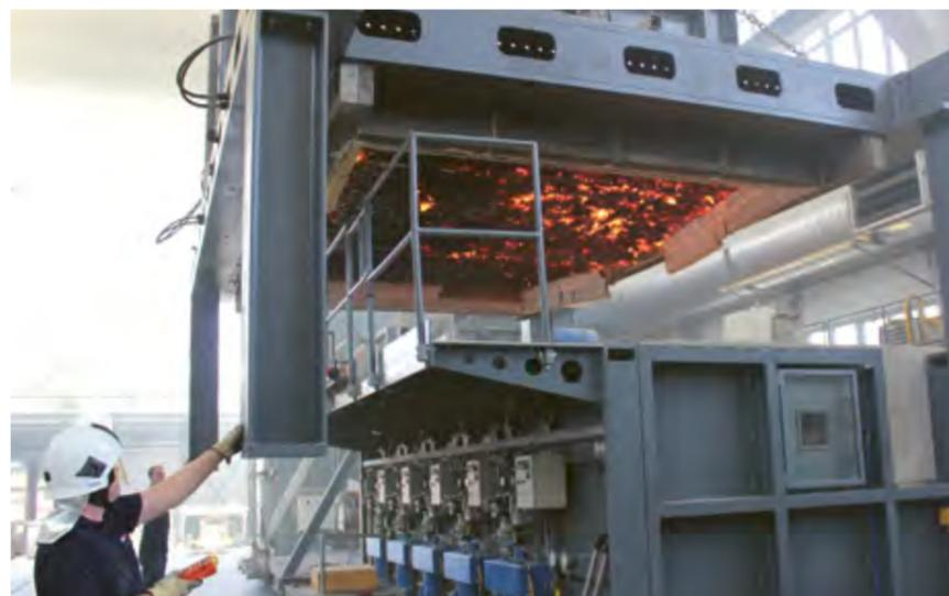
Um die Brandtauglichkeit der TS3-Verbindung zu testen, wurde eine CLT-Platte mit 4 Fugen in Brand gesetzt. Deutlich ist zu sehen, dass die TS3-Verbindung weniger tief abgebrannt war, als das Holz selbst. Tropfenbildung, Risse oder sonstige Schwächen des Materials waren nicht vorhanden. Ein Nachweis mittels Restquerschnitt ist auch für die TS3-Verbindung zulässig.
